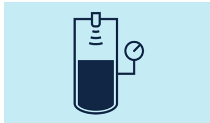
Hình 3.17: Cảm biến siêu âm phát giám sát mực nước, mức nhiên liệu
