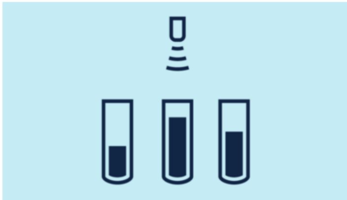
Hình 3.17: Cảm biến siêu âm phát giám sát mực nước, mức nhiên liệu
