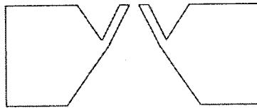
Hình 5.36. Sơ đồ nguyên lý van kiểu thú mỏ vịt.
