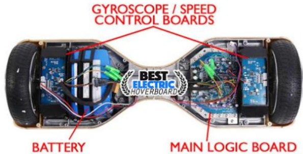
Hình 2.4. Một số ứng dụng của con quay vi cơ chế tạo bằng công nghệ MEMS
