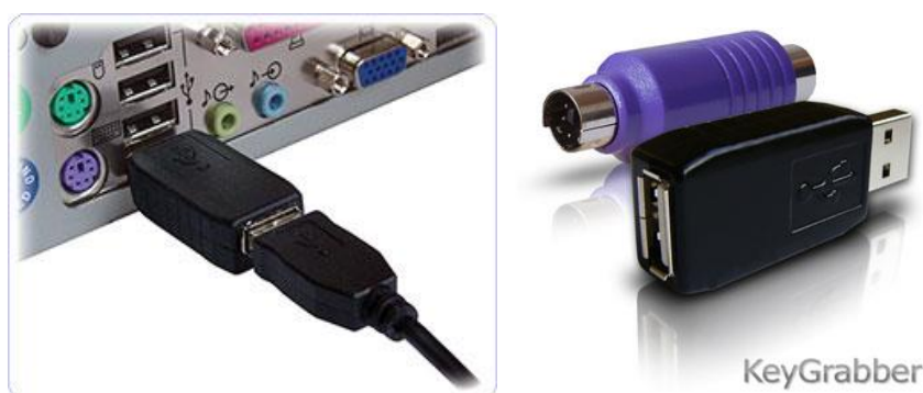
Hình 2.7. Mô đun Keylogger phần cứng và cài đặt trên máy tính để bàn
