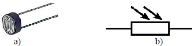
Hình 8.6: Hình dạng của quang điện trở; a) Hình dạng thật, b) Ký hiệu.
