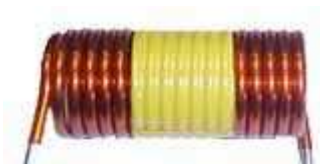
Hình 9.2a Cuộn dây lõi không khí
