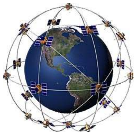
Hình 3.5: Phân bố các vệ tinh trên mặt phẳng quỹ đạo xung quanh Trái đất
