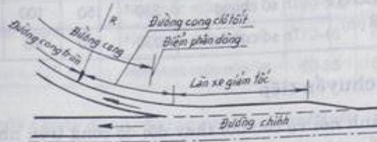
Hình 2-28. Bán kính đường cong và quá độ độ cong tại địa điểm tách dòng khỏi đường chính
