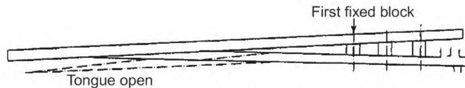
**Fig. 7.3** Fixed heel switch
