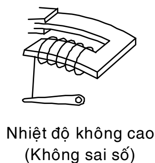
Hình 1.6 Hoạt động của phần tử lưỡng kim.
