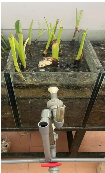
Hình 2.4. Thí nghiệm khả năng xử lý nước thải sinh hoạt của cây khoai nước ở hệ đất ngập nước
